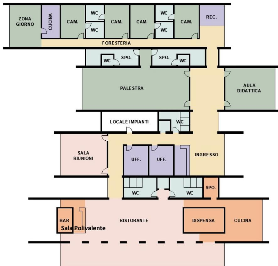
Figura 3.2 – Planimetria particolareggiata edificio principale
